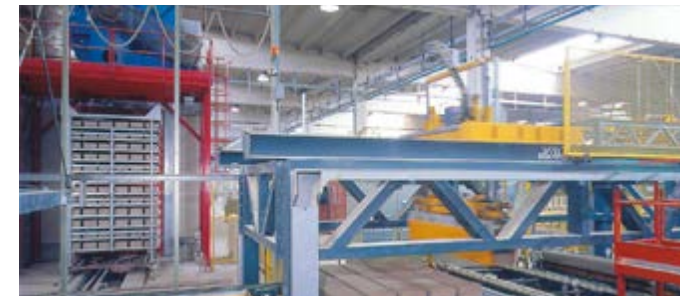
SISTEMI DI CARICO DEL PRODOTTO VERDE Green product loading systems
