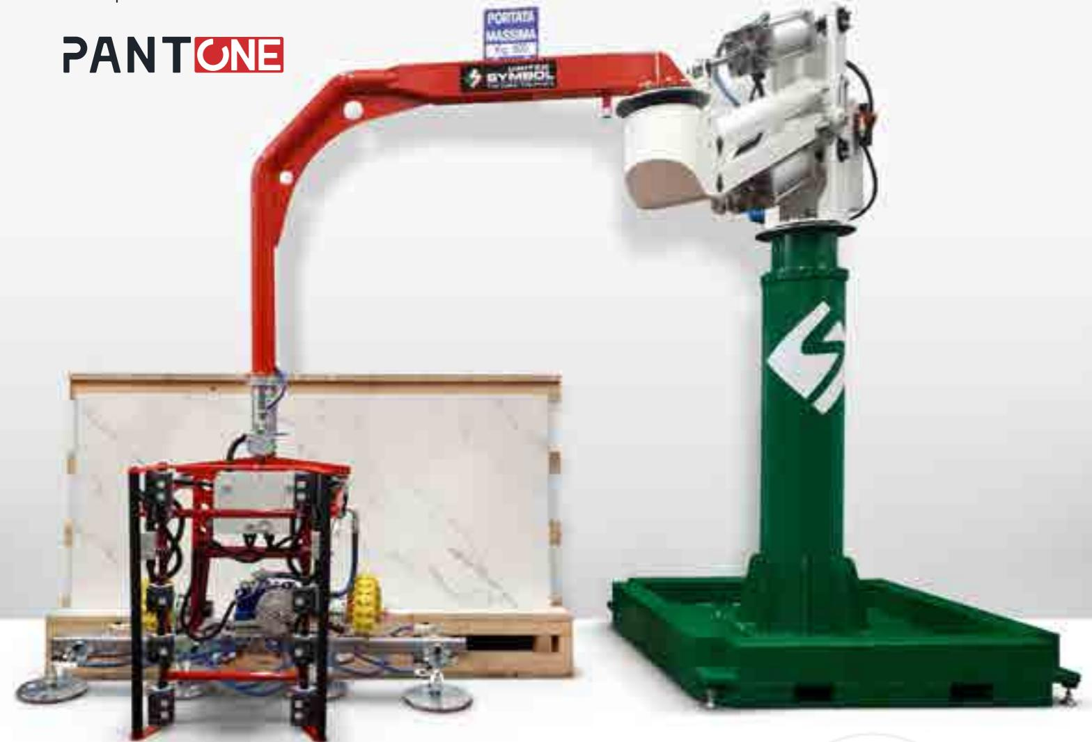
**MANIPOLATORE CON BRACCIO A PANTOGRAFO
